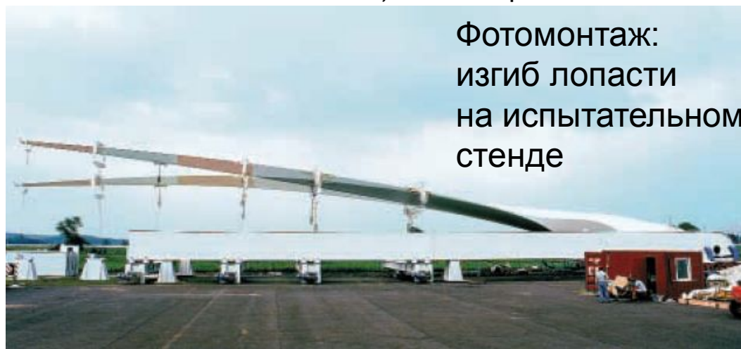
Ресурсные виброиспытания: 20 лет эксплуатации – за 3,5 месяца
