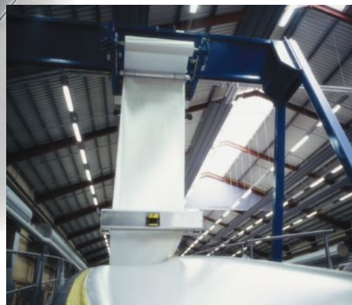
Автоматизированная подача армирующих материалов
