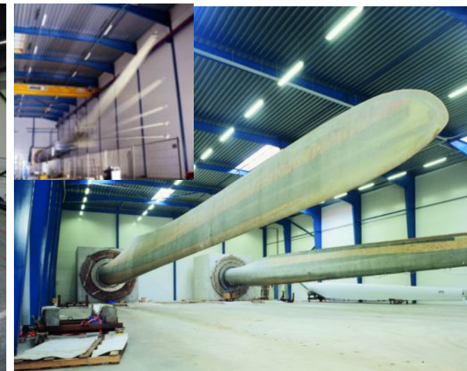
Ресурсные виброиспытания: 20 лет эксплуатации – за 3,5 месяца
