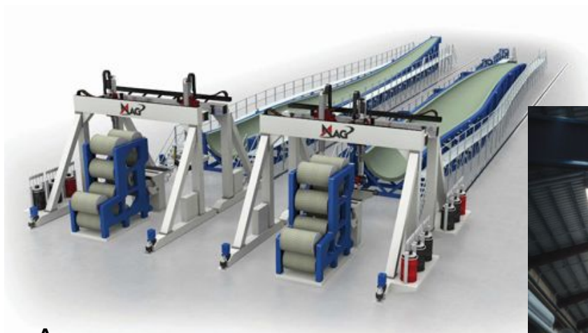
Автоматизированная подача армирующих материалов
