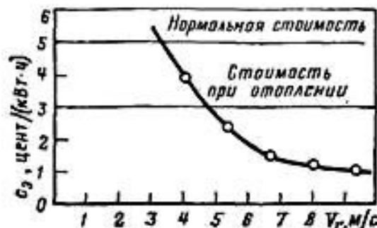
Влияние среднегодовой скорости ветра V_{г} на стоимость энергии, производимой ветроустановкой
