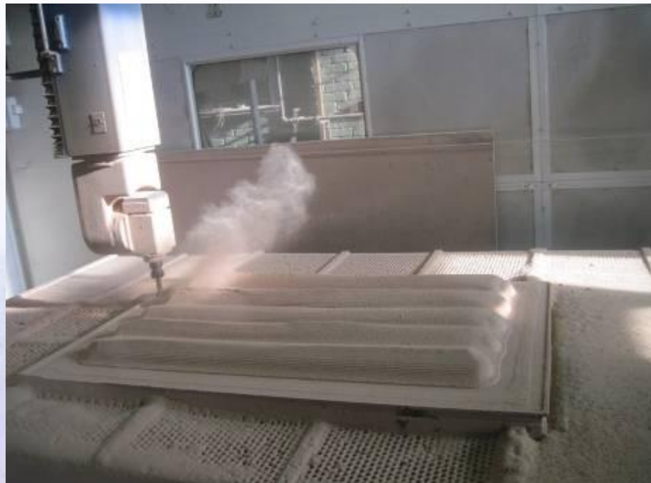
Обработка матрицы корпуса СВУ на станке с ЧПУ
