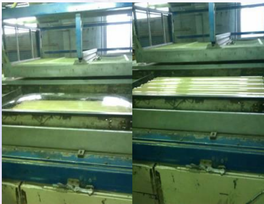
Процесс термовакуумформования прозрачного покрытия
